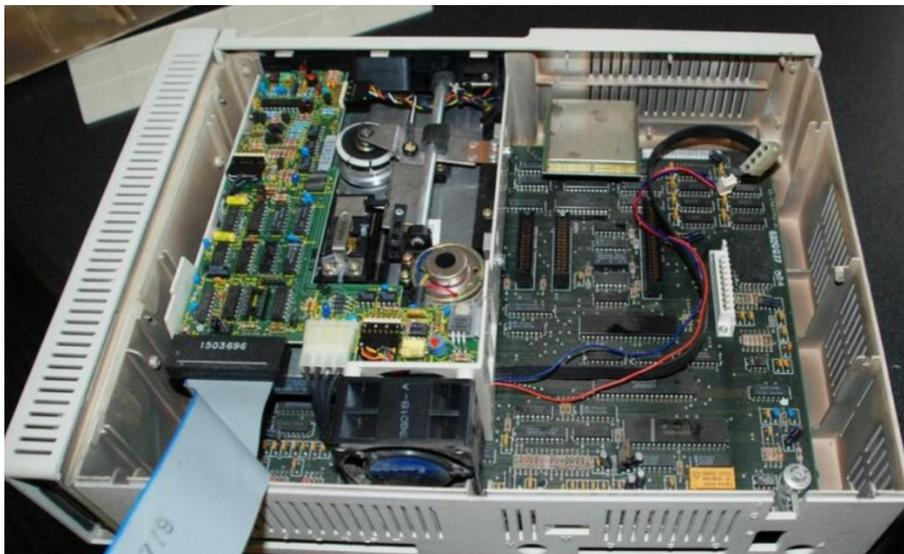
这个机箱里面的部件有风扇、一些小的电器部件、上面带有插槽的印刷电路板，当然还有很多电线接头。那些外部设备就是通过这一些电线或插槽来连到某个电路板上面的。只要我们仔细一瞧，就发现有一块大的印刷电路板，上面的插槽更多，并且，几乎所有的电线或者小的电路板都与它连在一起。这个电路板，在计算机术语中叫做母版或主板（Motherboard）。为了看的更清楚，笔者用一个比上面计算机主板更小的主板来解说。
